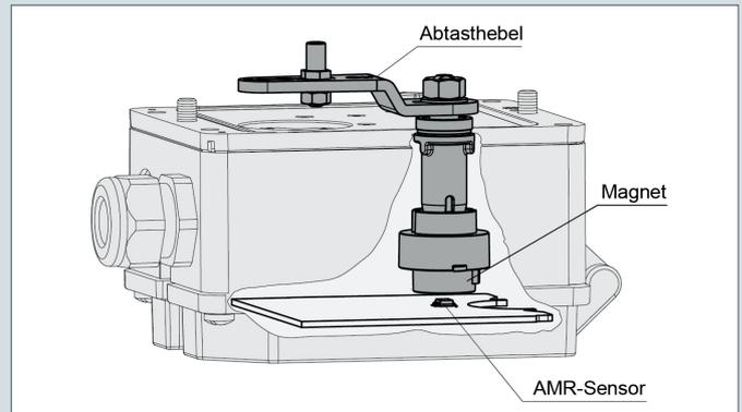
Bild 2: Geschützter, berührungsloser Wegsensor bei Typ 3725 und der neuesten Stellungsregler-Generation von SAMSON
