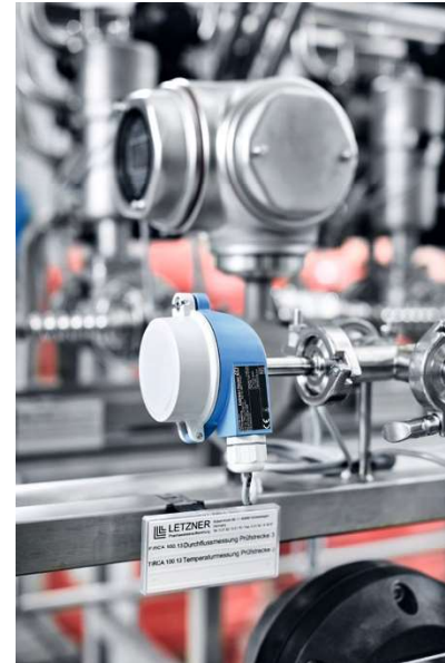
Messtechnik im Prüfstand: vorne schnellansprechende Temperaturfühler des Typs iTHERM TM411 mit QuickSens Technologie, im Hintergrund Massedurchflussmessgeräte des Typs Promass E 300 und Drucktransmitter des Typs Cerabar M PMP55.
