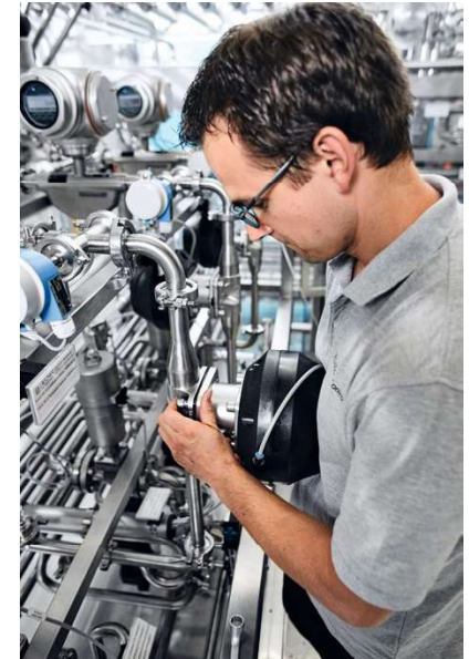
Daniel Tschunko, Mitarbeiter bei SED Flow Control, spannt ein Membranventil in den Prüfstand ein.
